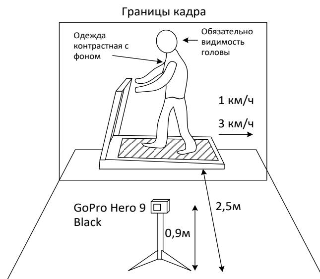
Рис. 1. Схематическое изображение стенда видеорегистрации походки.
